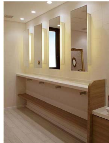
隣の人の視線が気にならないように個別鏡を採用。荷物配慮として2段式の棚を設置し、棚の下にフックも取り付けしている。
